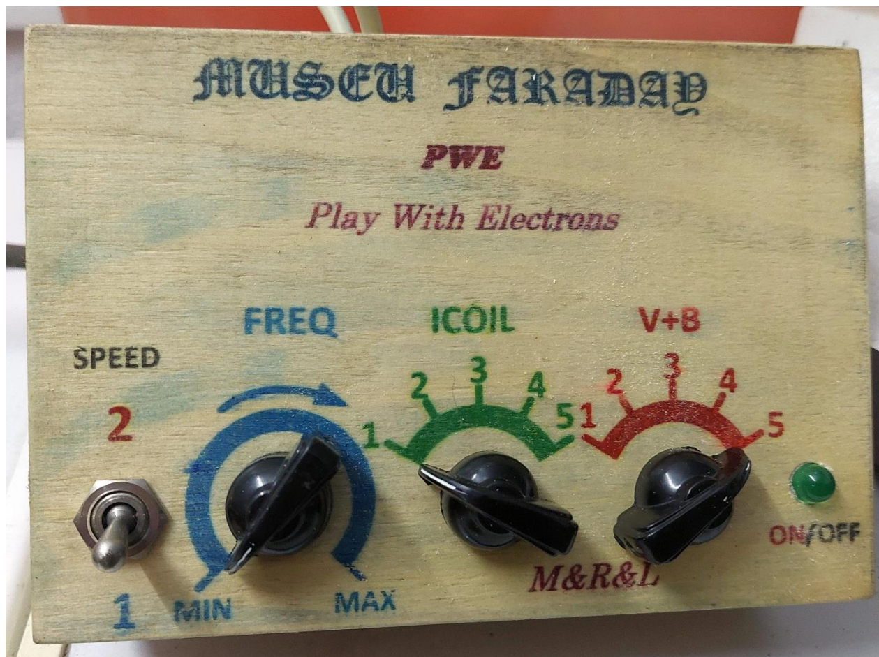
Fig. 7 – Módulo PWE de controlo alternativos da ampola Leybold 55557.
