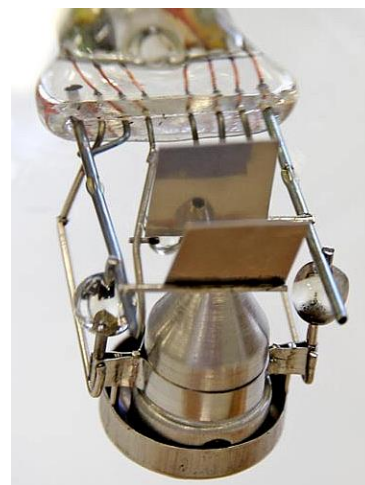
Fig. 2 – Canhão eletrônico do CRT.
