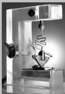
Transistor original, Réplica demonstração, Símbolo do transistor / Original transistor, Demonstration replica, Transistor symbol.
