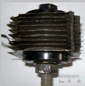
Retificador de Óxido de Cobre. Foi a primeira aplicação industrial do semicondutor óxido de cobre, em 1925 por L Grondahl.
