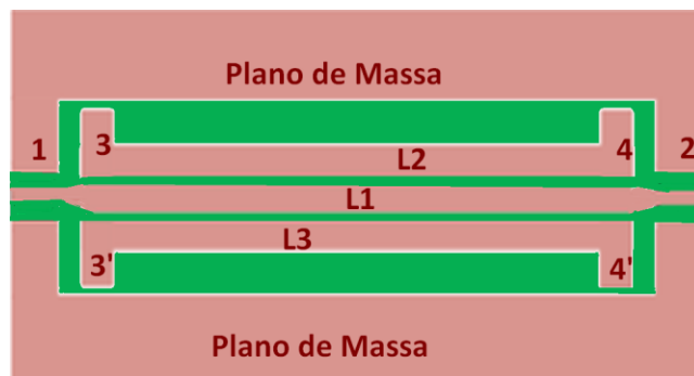
Fig. SA4 – Estrutura das linhas para o sensor de SWR.
