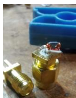
Fig. BA4 – Balun B0 com terminação de 220 \Omega .
