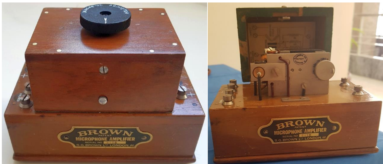
Fig.1. - Amplificador baseado em microfone de carbono (Museu Faraday) Coleção de Moisés Piedade.
