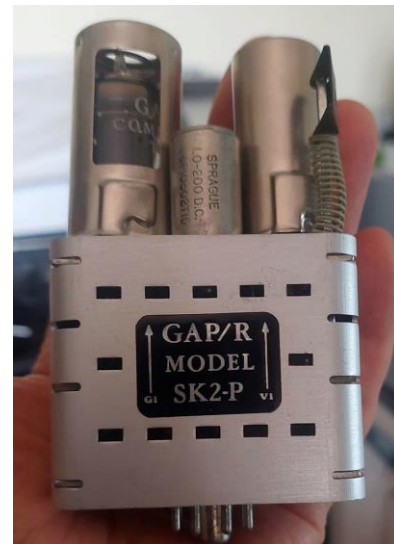
Fig. 6 – Amp. Estabilizador GAP/R SK2-P. (Museu Faraday)
