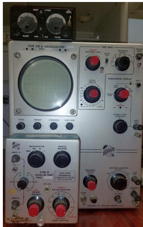
Fig.5 – Osciloscópio e temporizador associados ao TR-10.
