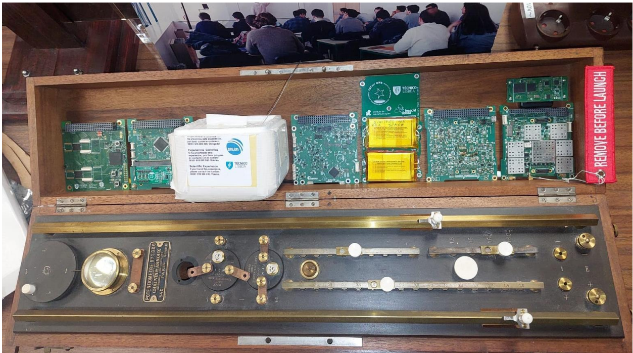
Fig. 2- Potenciômetro embestado na caixa de transporte e módulos do ISTSat-1.
