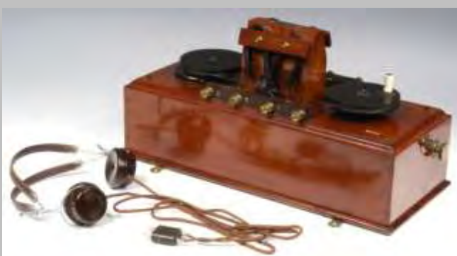
Fig. 2 – Marconi Magnetic Detector "Maggie" [3].
