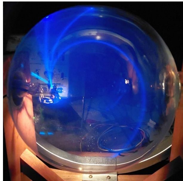
Fig.2 – CRT Leybold 55557 com trajetória espiral e feixe de trajetórias obtidas com modulo PWE.
