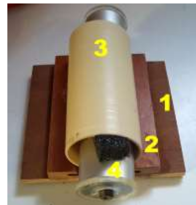
Fig. 17- Protótipo para experiência de deslizamento: 1- Placa base; 2- Placa de suporte; 3 - tubo de transporte de carga; 4 - carga.
