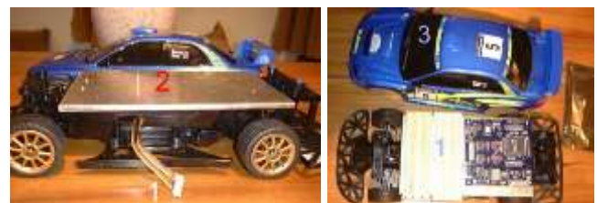
Fig. 3 - O chassis de alumínio para suportar os projetos dos alunos.
