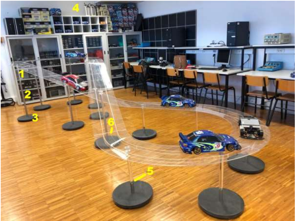
Fig. 22 - Vista geral da pista de chapa acrílica do SUBAH. Ao fundo pode ver-se uma garagem (4) para 12 SUBAs convencionais.
