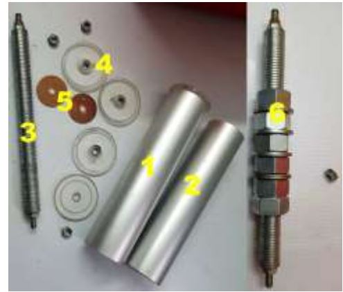
Fig. 16 - SUBA rolos: 1 – Cilindro exterior; 2- cilindro interior; 3 - eixo com massa; 4- rodas dos cilindros; 5- fixadores de rotação; 6 – eixo com massas adicionadas.
