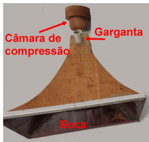
Fig. 17 - Corneta quase pronta e câmara de compressão
