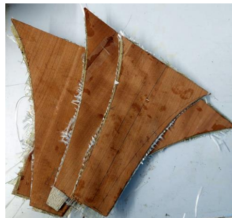
Fig. 15 - Lâminas curvas de madeira compósita.
