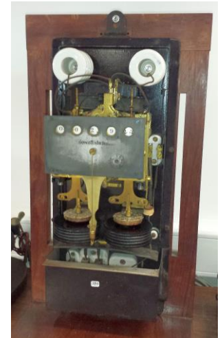
Fig. 3 – Museu Faraday Contador de energia Aron.
