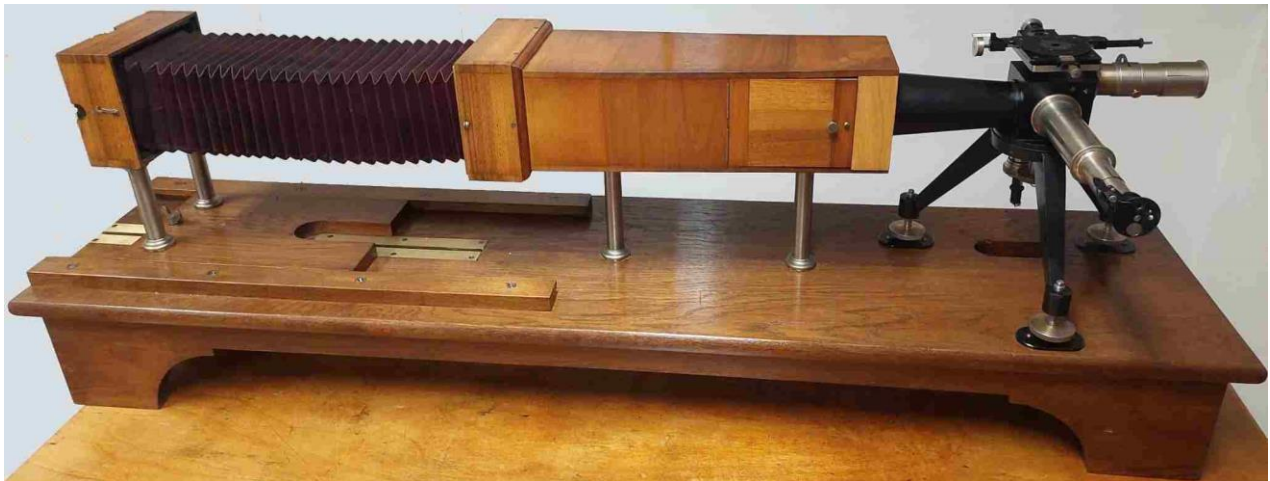
Fig. 7 - Microscópio de Le Chatelier restaurado (em exposição na sala Newton do Museu Faraday).
