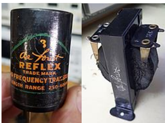
Fig. 4 - Transformadores de RF e de áudio. Tabela de Bandas de frequência do rádio D10 em função da posição dos transformadores de RF. RF and audio transformers. Table of the frequency bands of the D10 radio as a function of the position of the RF transformers
