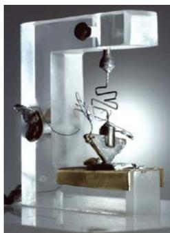
**Fotografia do primeiro transístor de contactos metálicos pontuais.
