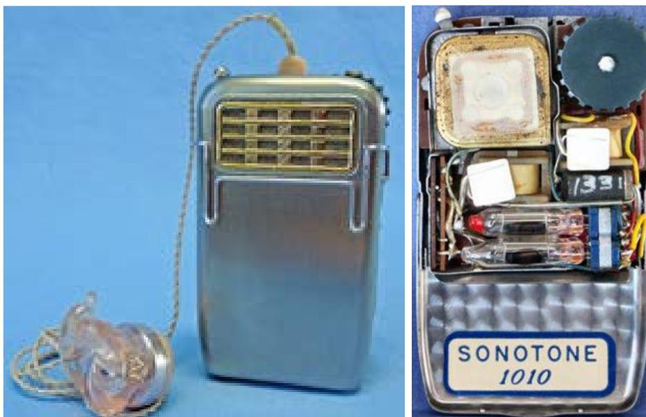
Primeiro aparelho auditivo usando um transistor (1952).
